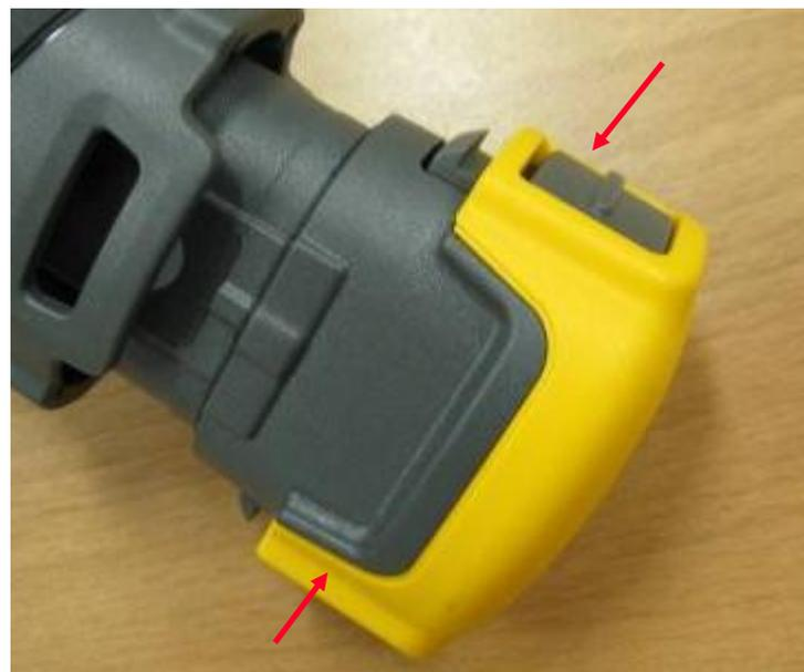
按住电池两端弹簧按键，即可卸下电池；将电池标签向左插入电池仓，推入后听到“咔哒”声表明电池已安装到位。
