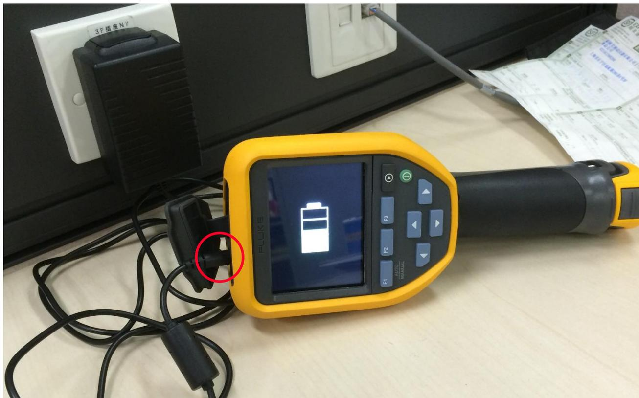
在热像仪顶部充电端口充电，绿灯满格即可。
